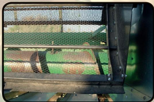
Les rabatteurs sont munis d'une bande caoutchoutée au bout des pales, ce qui permet de nettoyer les plateaux et le canal entre chaque plateau. Les bandes limitent ainsi le bourrage et la perte de graines.
