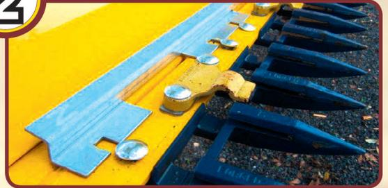
Insérer le Profil Z sous les boulons de doigts.
